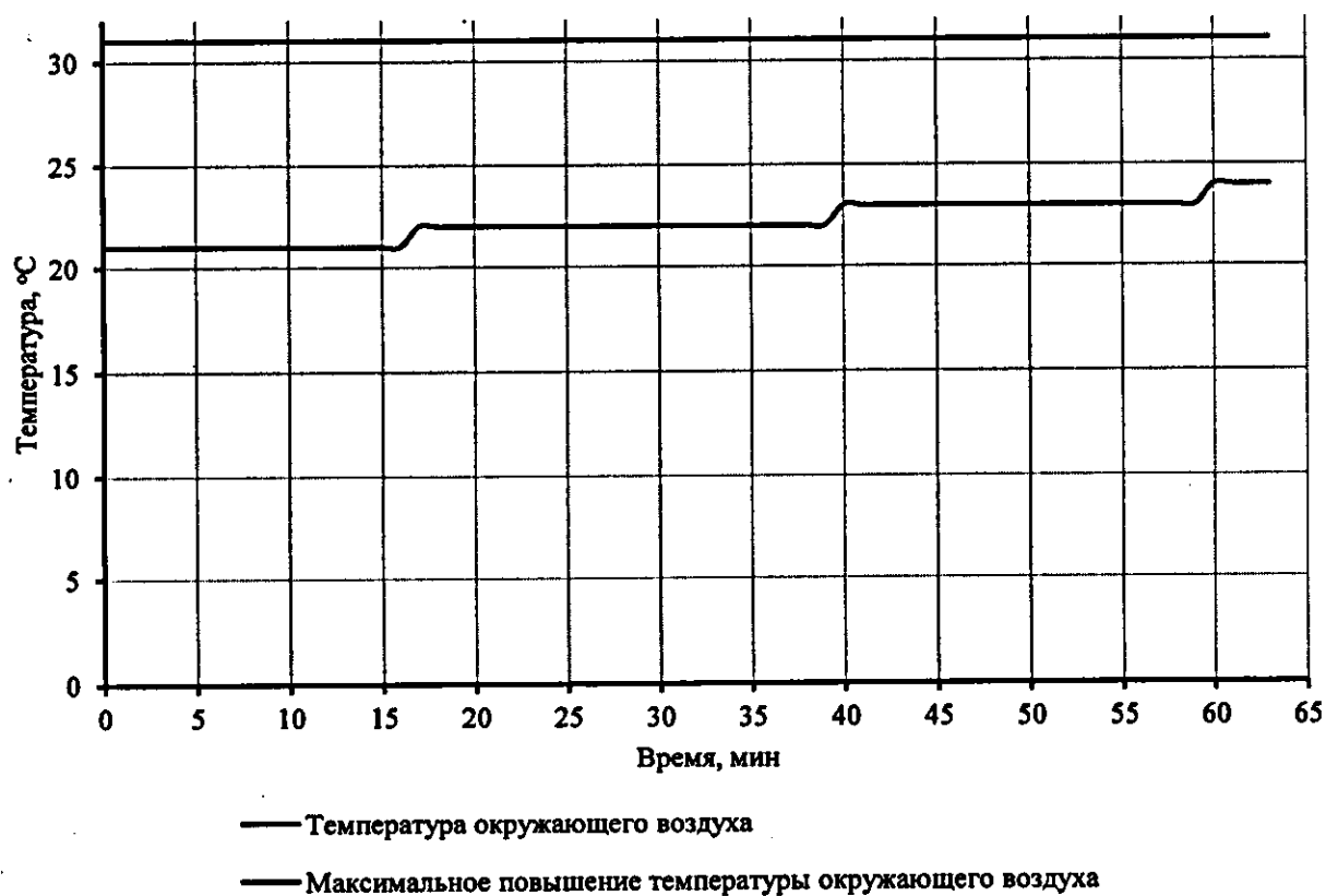
Рисунок 7. График изменения температуры окружающего воздуха при испытании образца № 439/1/1/1
